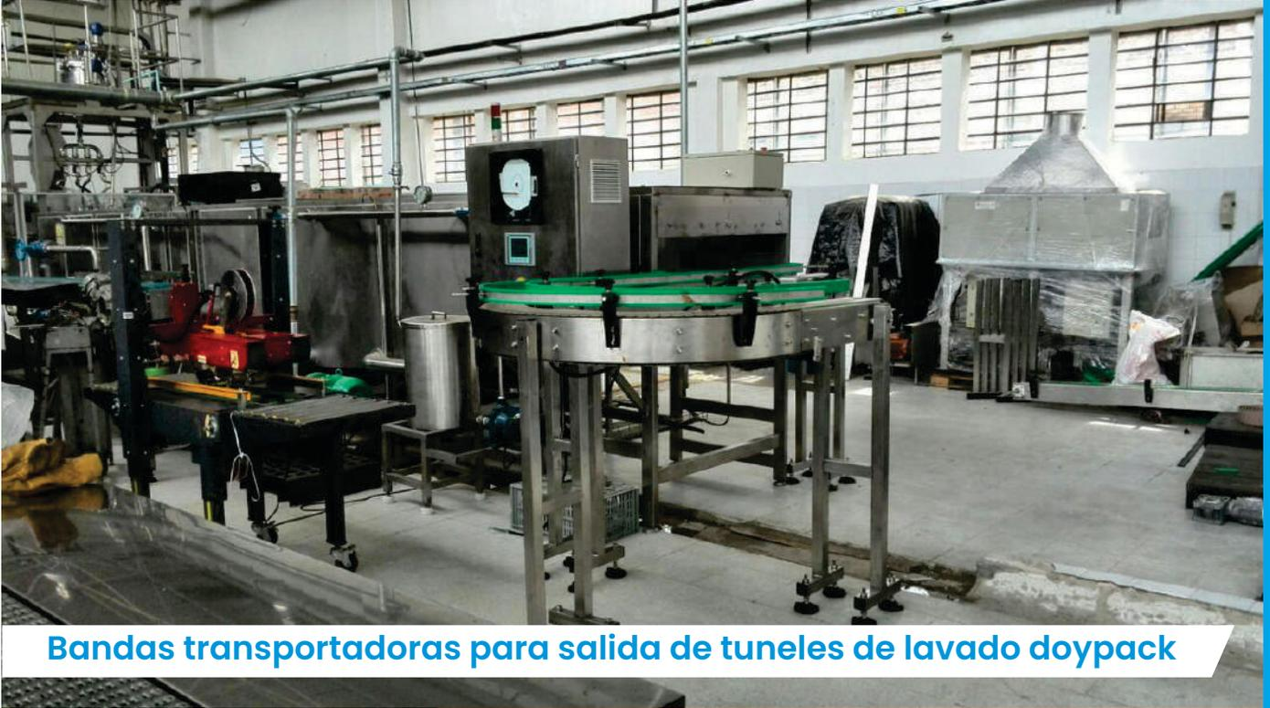
**Bandas transportadoras para salida de tuneles de lavado doypack**
