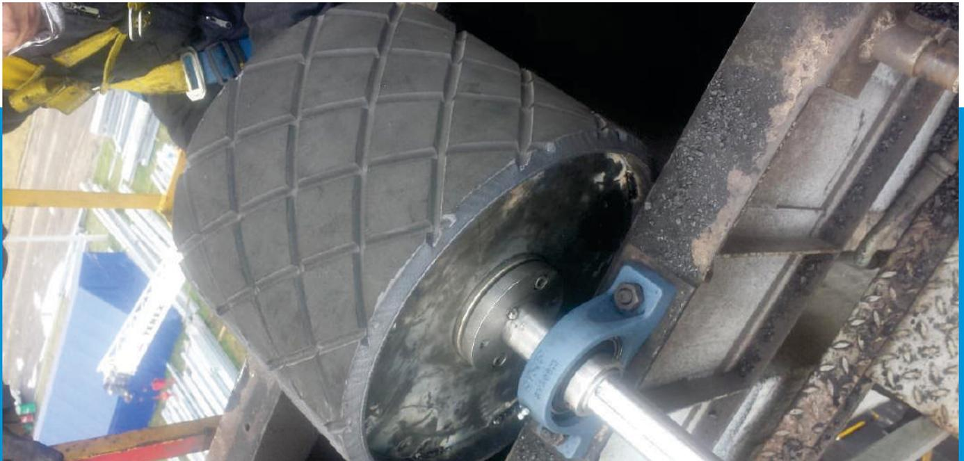
**Rodillos, sistemas de fijación, transmisión para elevadores y bandas transportadoras**
